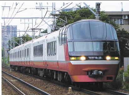
名古屋鉄道1200系電車は、1000系「パノラマsuper」に連結するために性能を合わせた専用一般車として誕生しました。特別車1000系2両＋一般車1200系4両の6両編成で特急運用を主に使用され、この併結編成を総称して1200系と名乗っています。2号車に車掌室、3号車にトイレと洗面所のある車両はA編成と呼ばれています。
